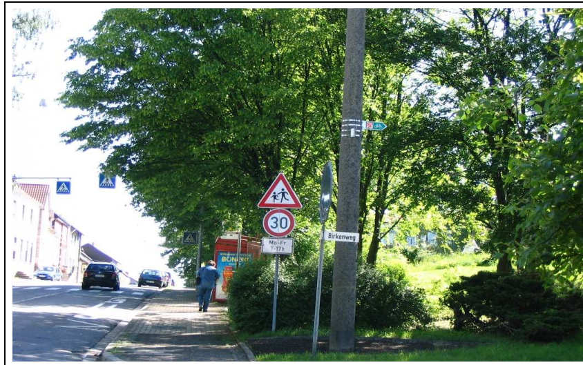
Bild 5-22: Zu hohe Anbringung eines Wegweisers an einem Baum (Friedrichsthal)
